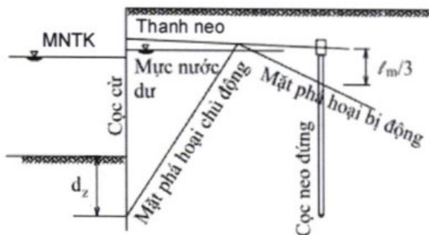
Hình 1.4- Vị trí lắp đặt cọc neo đứng
