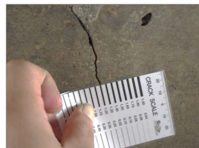
Ảnh 2.2.1 Ví dụ về khảo sát trực quan sử dụng thiết bị đơn giản
