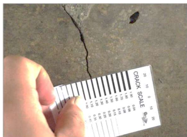
Ảnh 2.6.3 Đo chiều rộng vết nứt bằng thước đo vết nứt
