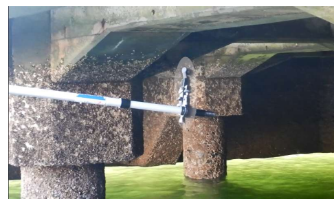
Hình 2.2.4 Ví dụ về cách sử dụng máy ảnh treo
