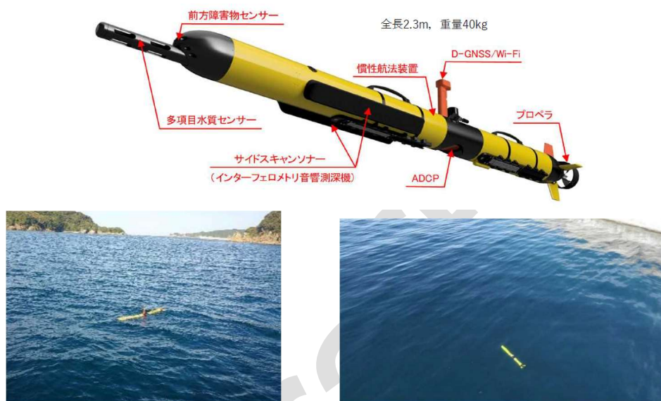
Hình 2.3.6 Ví dụ về sử dụng phương tiện tự hành dưới nước AUV ( https://www.mlit.go.jp/kowan/content/001864027.pdf )
