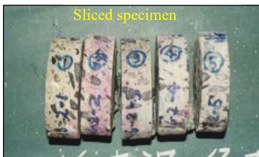
Ảnh 2.6.4 Lấy mẫu lõi và mẫu lõi cắt theo chiều sâu
