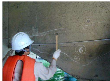
Ảnh 2.2.1 Khảo sát trực quan kết cấu phần trên của cầu tàu
