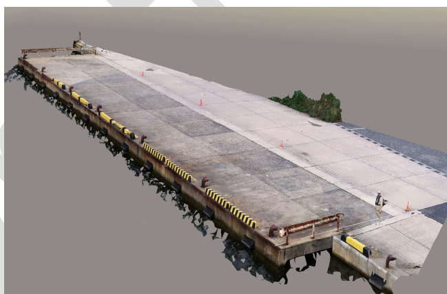
Hình 2.3.1 Ví dụ về mô hình 3D của cầu cảng được tạo từ ảnh chụp bởi UAV
