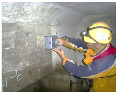
Hình.2.6.1 Khảo sát cốt thép bên trong bằng phương pháp cảm ứng điện từ
