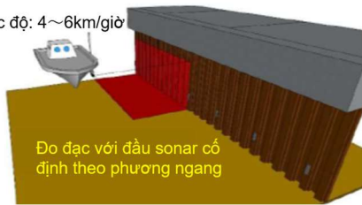
Hình 1 Hình ảnh đo đạc dưới nước bằng máy quét 3D dưới nước
