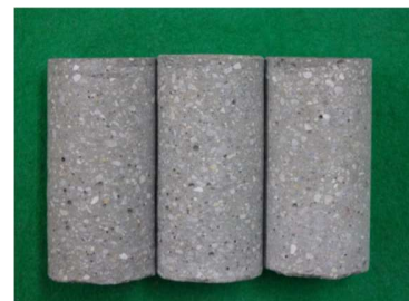
Ảnh 7(b) Hình dạng mẫu lõi trong vùng không có cốt thép
